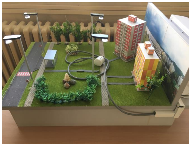
Učebná pomôcka pre odbor 2697 K mechanik elektrotechnik Inteligentné úsporné verejné osvetlenie pomocou LED svietidiel
